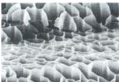
電子顕微鏡（倍率170倍）で撮影したアクティブドライの内部構造写真
