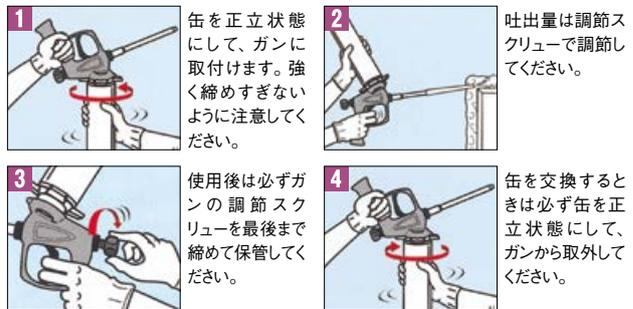
1 缶を正立状態にして、ガンに取付けます。強く締めすぎないように注意してください。
