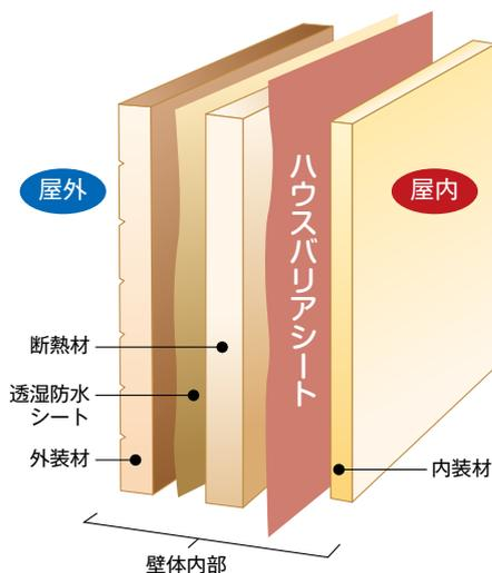
ハウスバリアシートは、低エネルギー、低コストで高水準な気密性と、断熱材内部の結露を防止する2つの目的から、優れた防湿性、耐久性を考慮開発された商品です。
