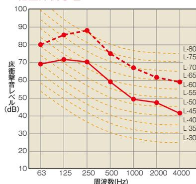
—●— フロアー 12mm+アスファルトマット8mm+合板12mm
