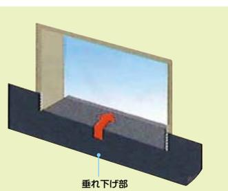
②上部を窓台側に折り曲げ、タッカーで固定してください。水切りシート外側、垂れ下げ部は、タッカーで固定せず垂らした状態にしておき、次施工の透湿シート等を下にもぐらせて施工します。
