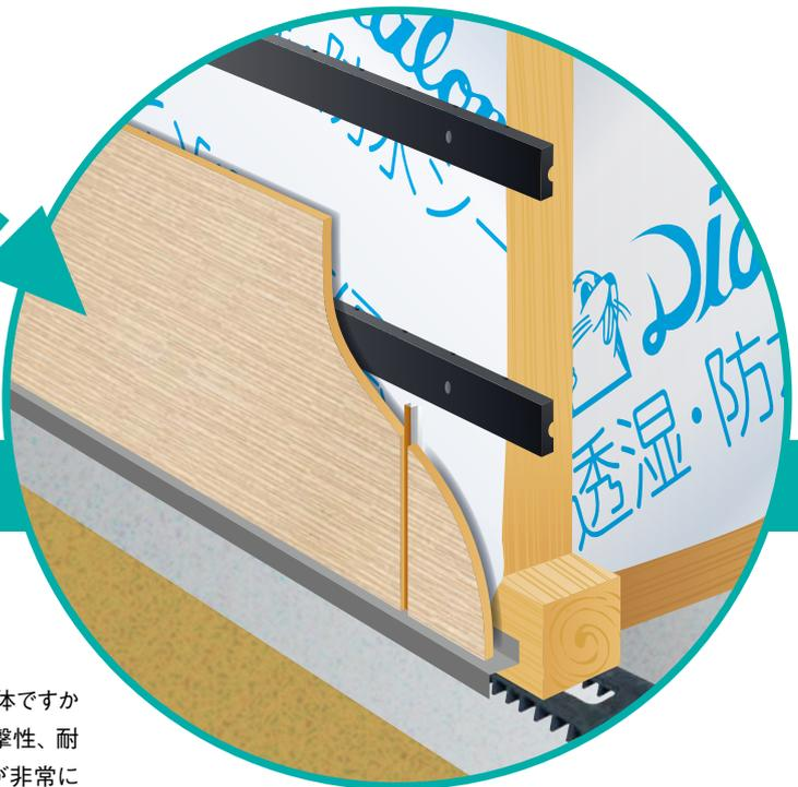
外装下地用 ダイアロン通気胴縁 通気溝加工付
