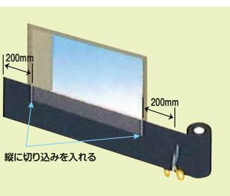
①シートを開口部幅+400mm以上の寸法でカットしてください。カットしたらタッカーで固定します。
